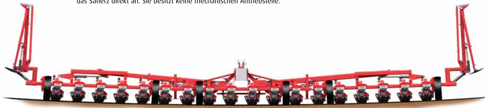
Optimale Anpassung des Rahmens an die Bodenkontur. Die Zeichnung zeigt den Bodenausgleich eines 18-reihigen parallel hydraulisch klappbaren Rahmens in 9,00 m Arbeitsbreite.
